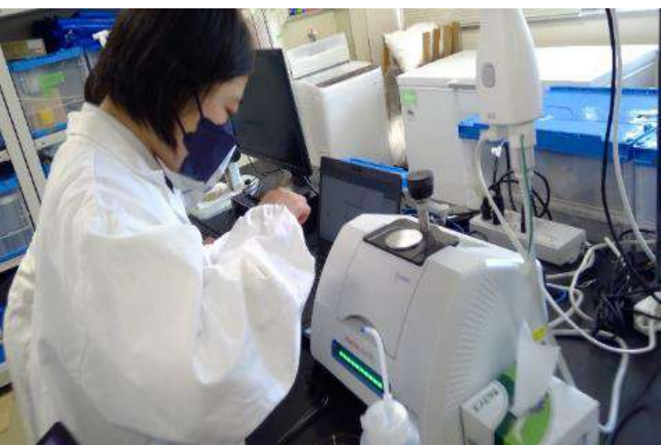
FT-IRで材質を測定
