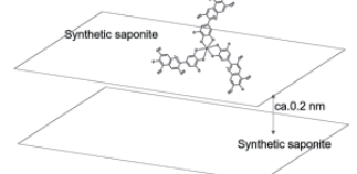
図1 アントシアニンにアルミニウムイオンを加え、合成サポナイトに吸着させたもの
